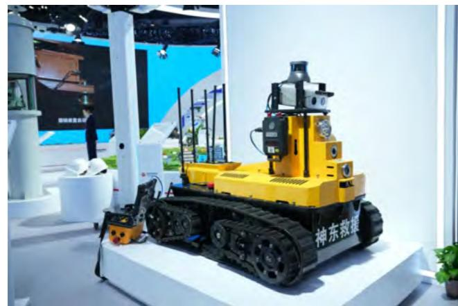
神东煤炭煤矿履带式巡检机器人
