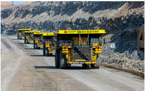
黑岱沟露天煤矿拥有国内载重最大的300吨级巨型无人驾驶卡车
